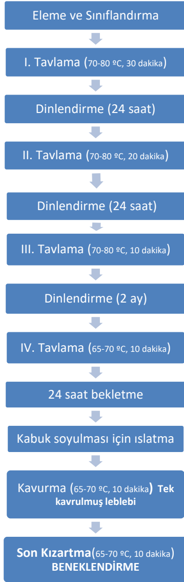
Şekil 11. Tek Kavrulmuş Günümüz leblebi Üretim Akış Şeması
